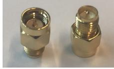
Fig. 5. SMA converters
